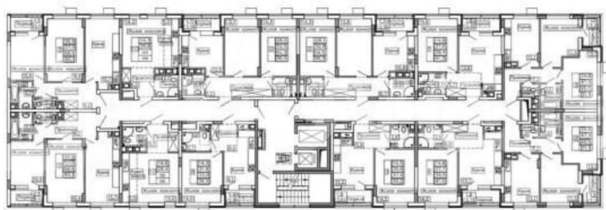
КОРПУС 1 (секции 1-2) Секция 2 План 2-11 этажей
