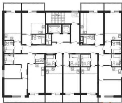
КОРПУС 1 Секция 1 План 9-16 этажей
