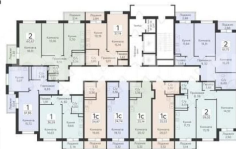
КОРПУС 5 (Секции 10,11) Секция 11 План 2-10 этажей
